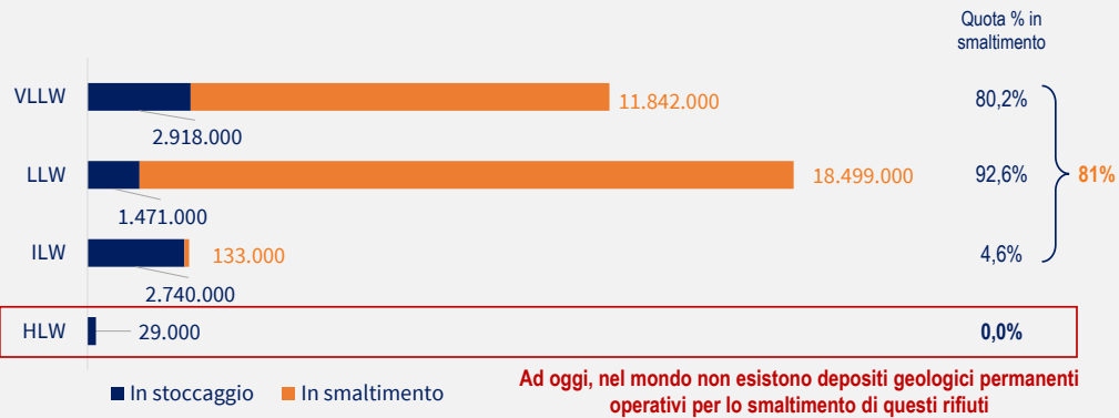
Figura 72. Volumi totali delle diverse classi di rifiuti radioattivi in stoccaggio e smaltimento a livello globale (m3), ultimo anno disponibile. Fonte: TEHA Group su dati del Rapporto IAEA «Status and Trends in Spent Fuel and Radioactive Waste Management, 2022» e altre fonti, 2024.
