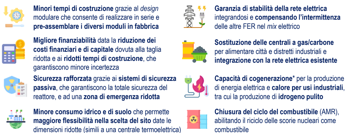
Figura III. Le caratteristiche peculiari del nuovo nucleare rispetto alle grandi centrali tradizionali (illustrativo). (*) Permette di modulare la produzione degli impianti da 100% elettrici ad un mix di elettricità e calore a seconda delle necessità del Paese e dei settori industriali. Fonte: elaborazione TEHA Group su fonti varie, 2024.
